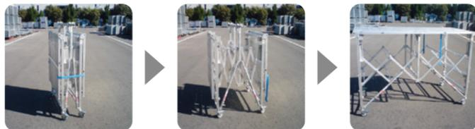
収納バンドを外し、振れ止め材のボルトを緩める。車輪のロックを解除し、蛇腹部をしっかりと開き、床板を回転させ上部へセットし、各部をロックしたら完成。(Sタイプを除く)
